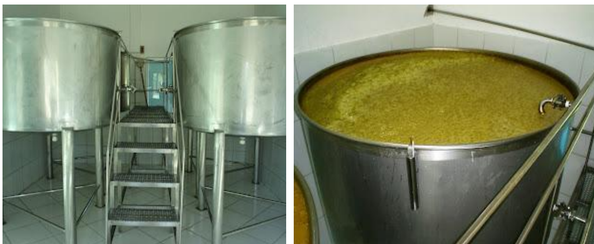
Figura 2: Modelo de dorna de fermentação construída em aço inoxidável.
