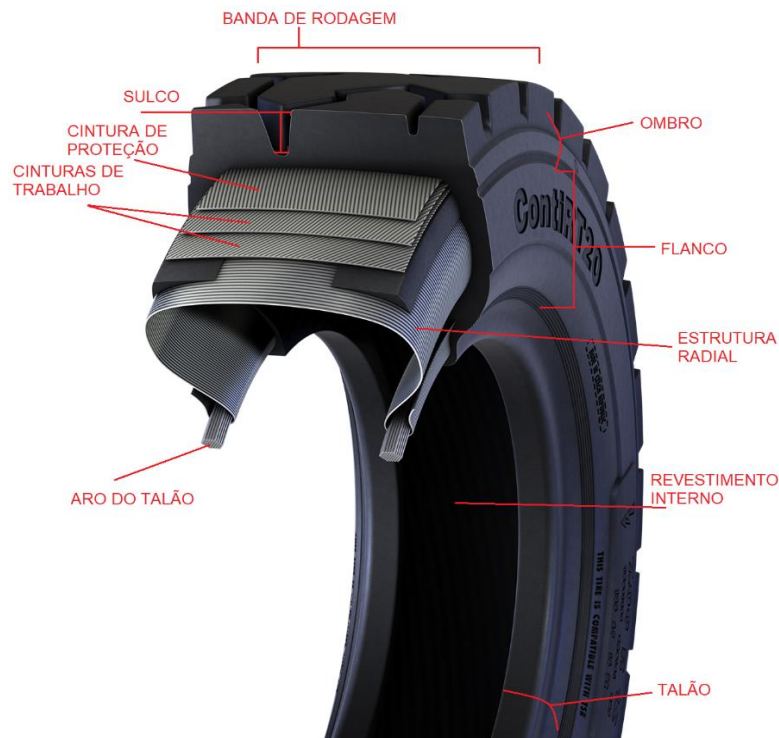
Figura 3 – Estrutura de um pneu radial
