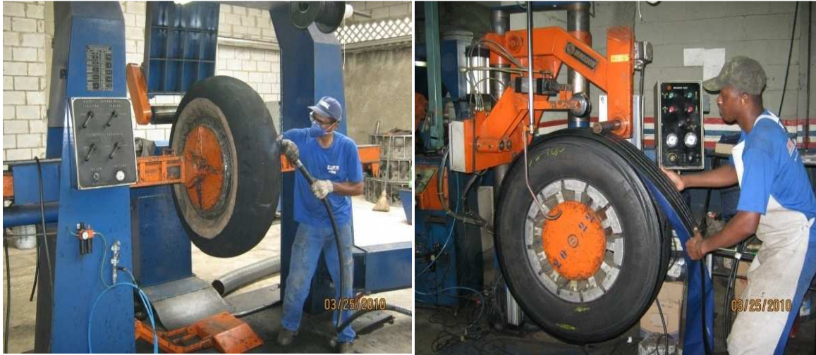
Figura 16: Raspagem e cobertura de um Pneu Recapado
