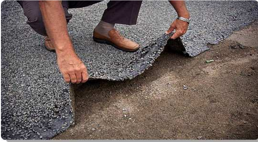
Figura 7: Asfalto Ecoflex proveniente de borracha de pneus inservíveis.
