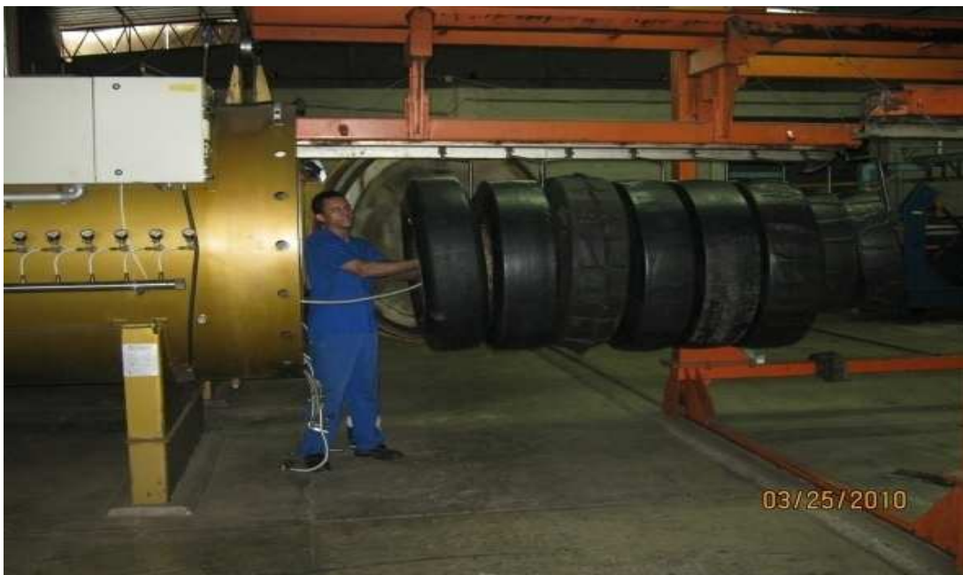
Figura 17: Pneus entrando dentro do Autoclave para receber alta pressão via temperatura.
