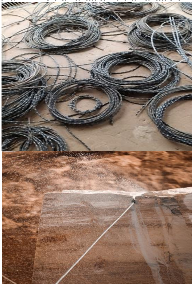
Figura 11 - Fio diamantado/Fio diamantado em uso.
