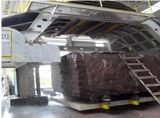
Figura 5 - Serragem de Bloco por Tear Multifios.
