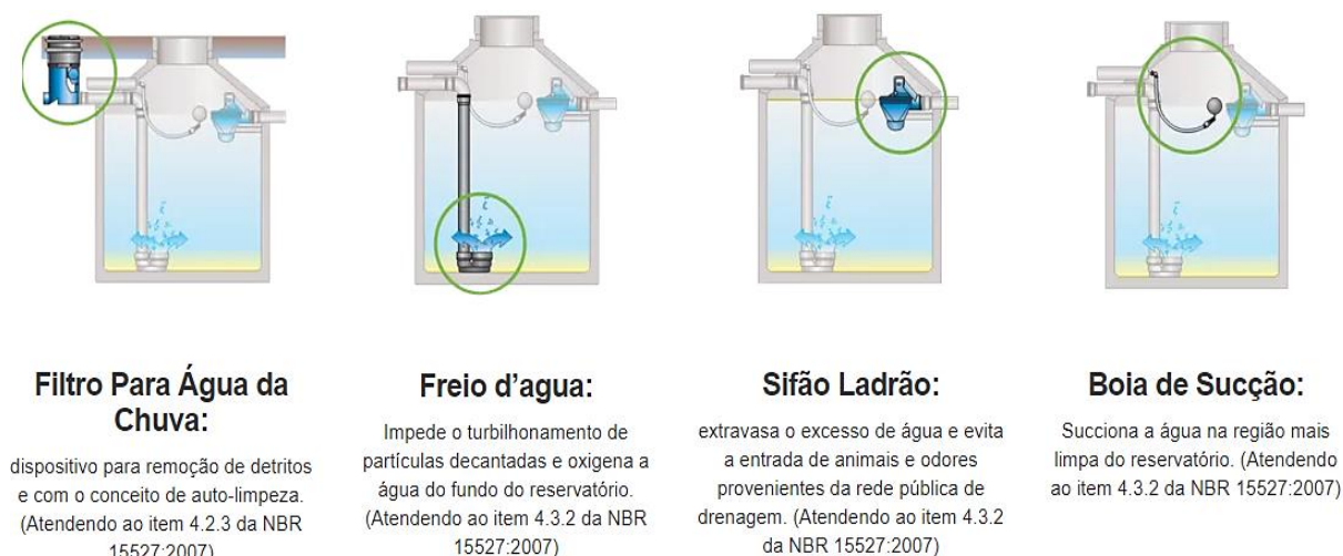
Figura 47 - Processo para Aproveitamento de Água da Chuva
